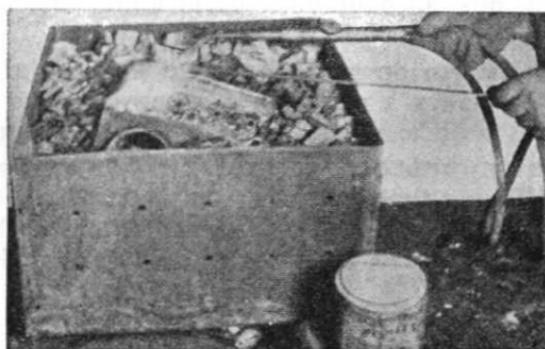
Obr. 47. Sváření na ohni z dřevěného uhlí.
