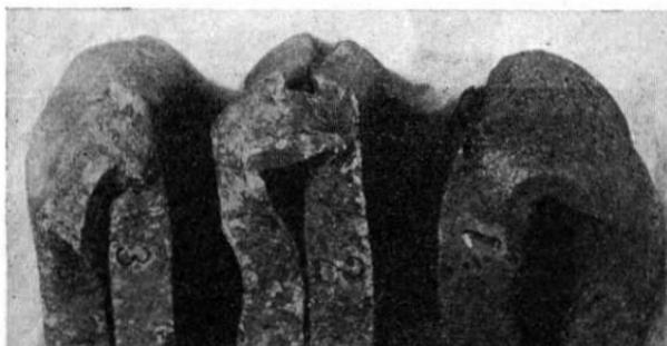
Obr. 94. **Ohybová zkouška za tepla.** (8 mm plech.)
