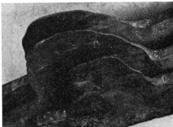
Obr. 95. Zkouška kováním.
