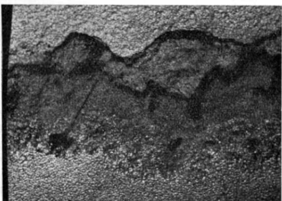
Obr. 150. Silně vyžraný svar nádrže z hliníku.
