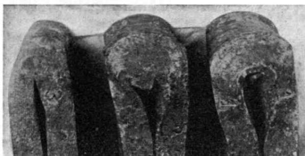
Obr. 93. **Ohybová zkouška za tepla.** (8 mm plech.)
