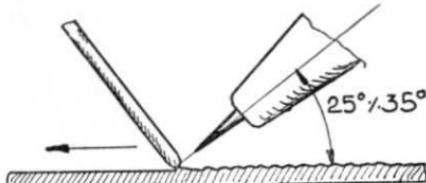
Obr. 148. Držení hořáku a drátu při svaření mosazi.
