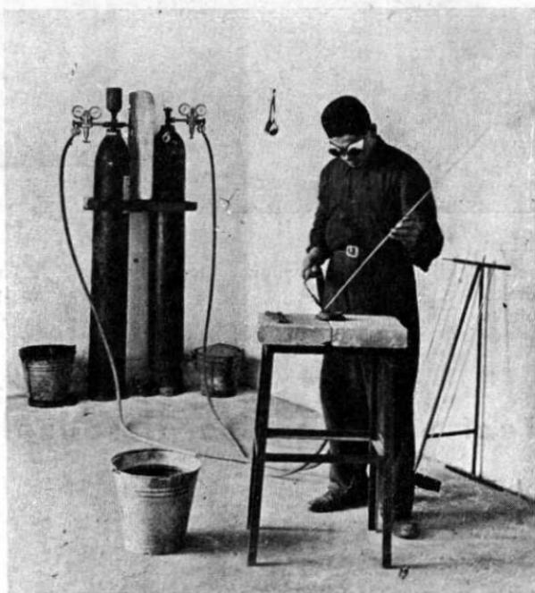
Obr. 3. Úplné svářecí zařízení pro dissousplyn a kyslík.
