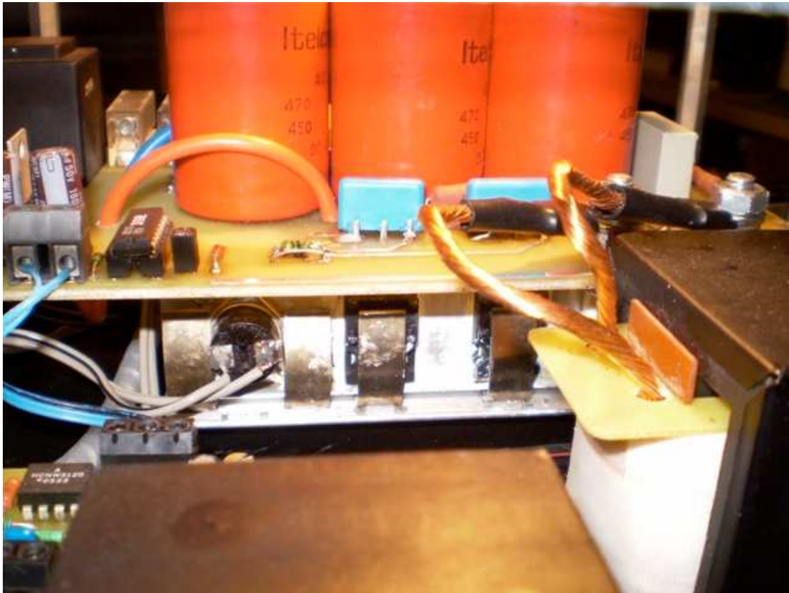
Obr.3: pohľad na hornú dvojicu tranzistorov, filtračné kondenzátory v medziobvode, teplotné čidlo, budič, RC členy a trafo.
